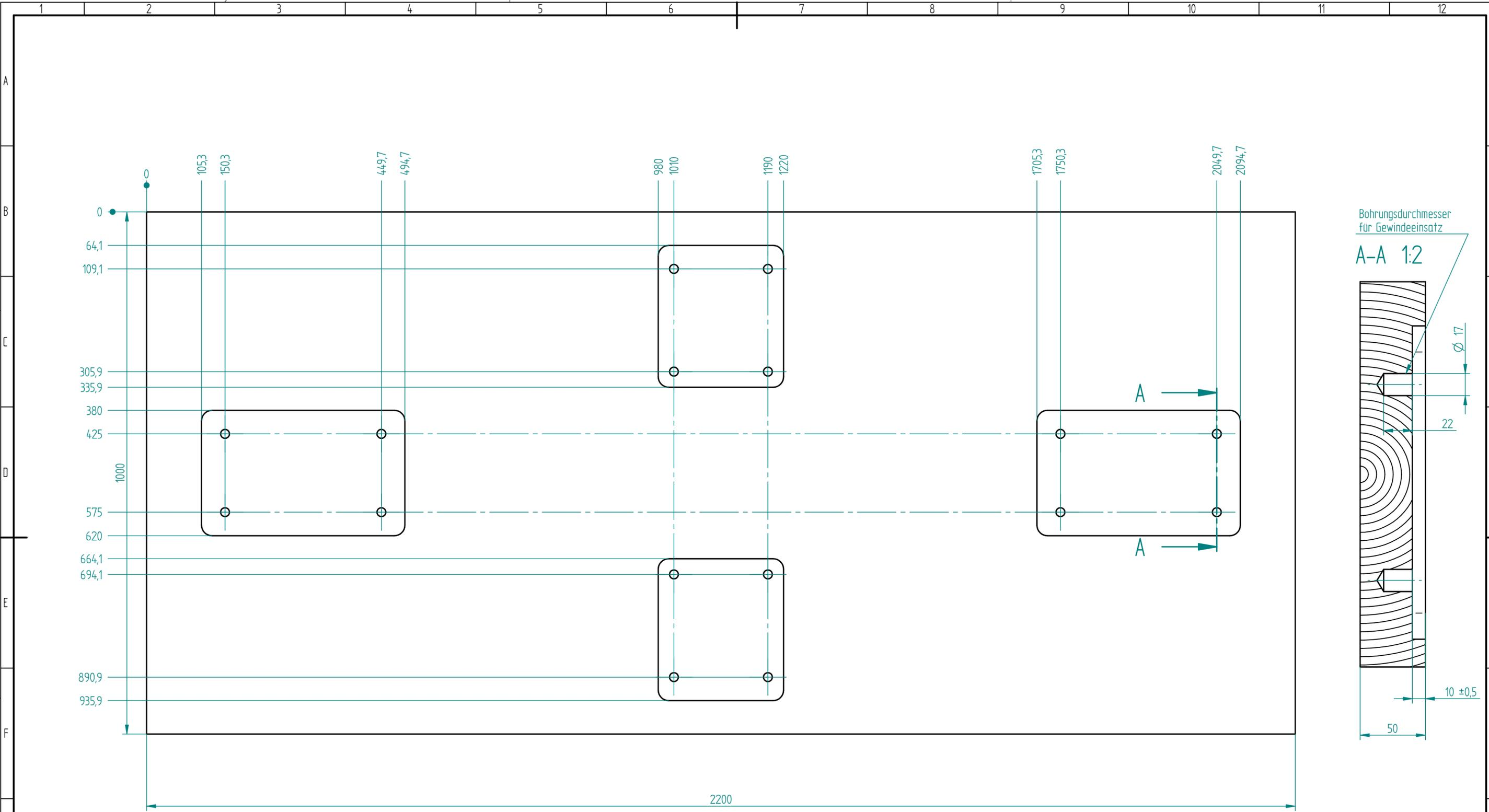
Bohrungsdurchmesser für Gewindeinsatz
