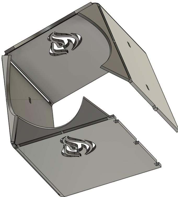
Die beiden äußeren Flächen in Richtung der Flügel knicken um 90 Grad
